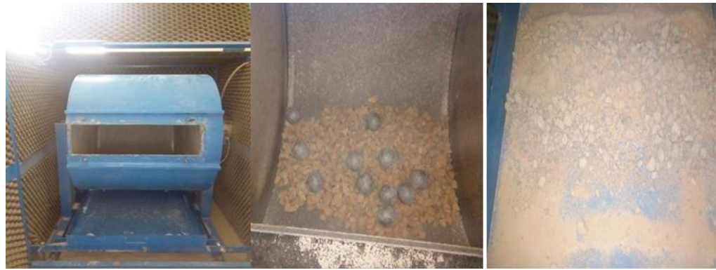
Appareil los Angeles matière avant l'essai matière après l'essai
