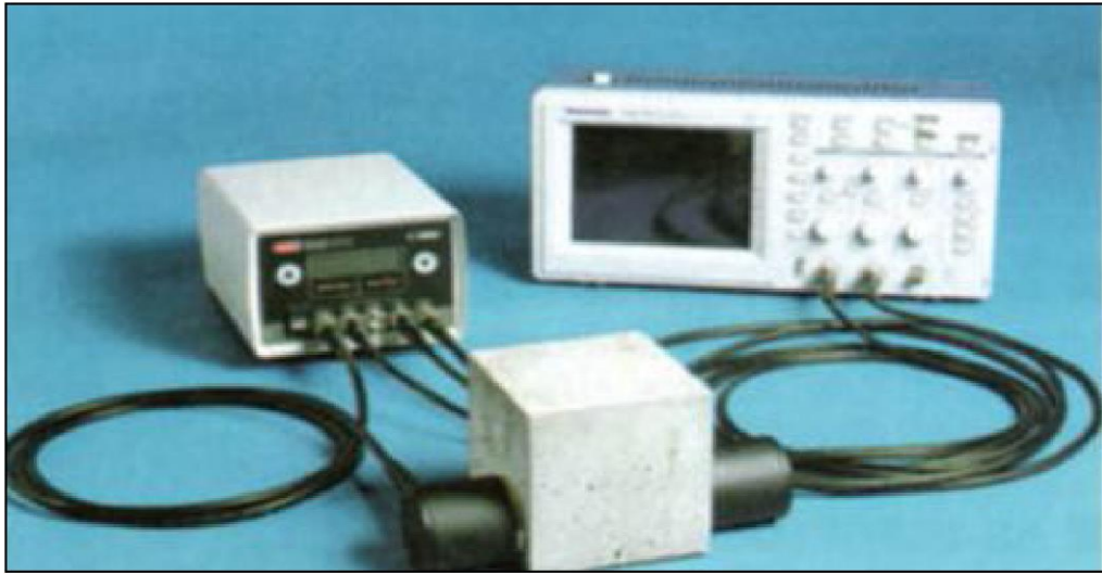
Photo.I.3 : Appareil d'auscultation sonore 58-E48 avec oscilloscope
