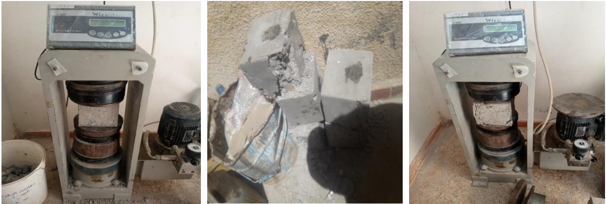
Photo II-8 : les différentes étapes de la compression de béton
