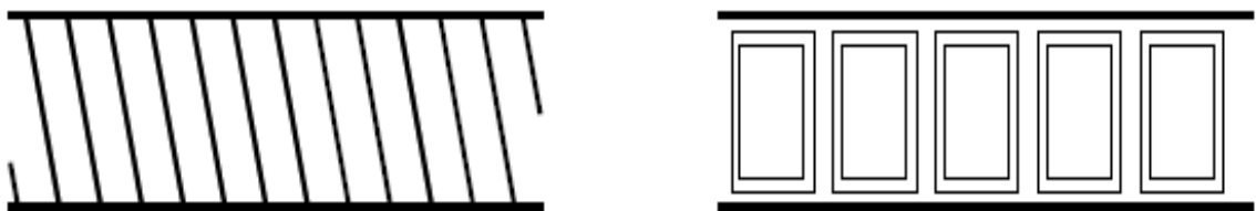
Figure. I.11 Schéma développé d'un rotor à cage classique et d'un rotor de machine asynchrone
