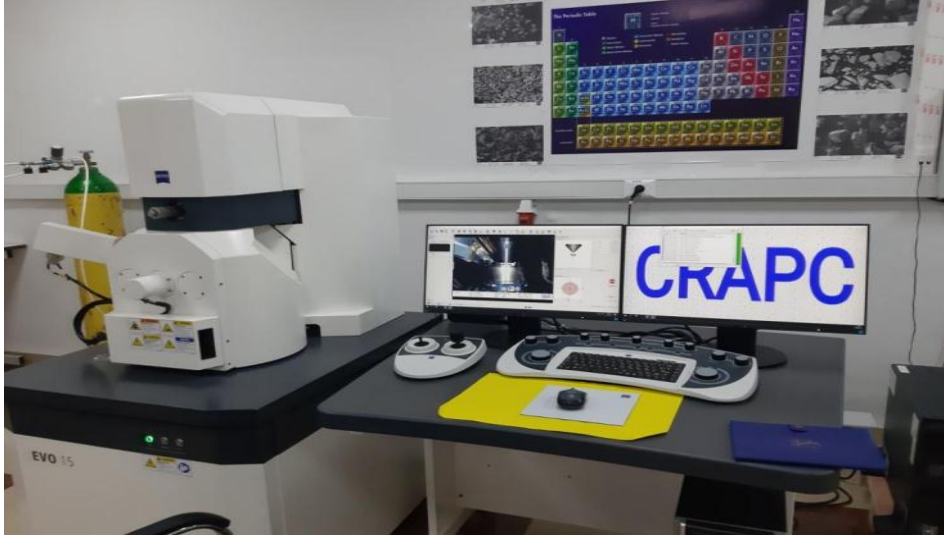
الشكل (22. 2): جهاز الماسح الضوئي المربوط بجهاز تشتت الطاقة السينية من نوع Zeiss Evo15.
