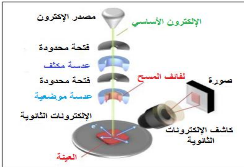
الشكل (17.2): تمثيل تخطيطي لماسح المجهر الإلكتروني (SEM) [76].
