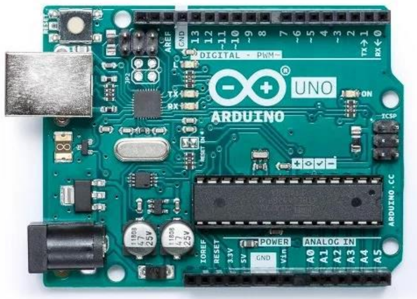
Figure II.1: Image réelle d'une carte Arduino UNO.
