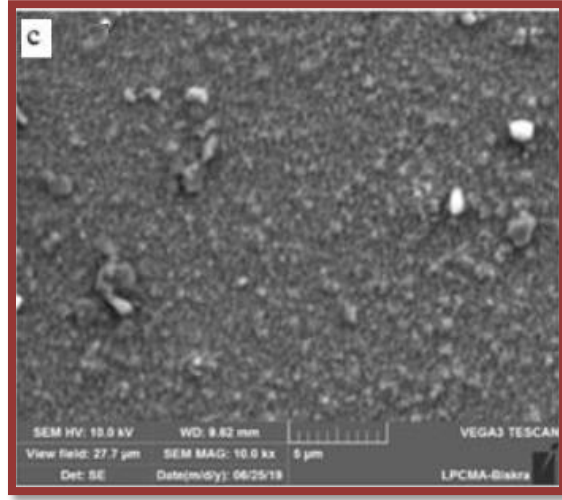
الشكل 16: صورة بالمجهر الإلكتروني الماسح عند التركيز 0.2M لطبقة ZnO/FTO .
