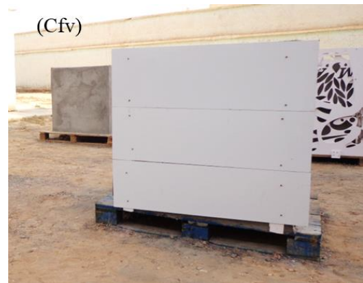
Fig. 3. Les deux cellules tests : (Cr) cellule de référence et (Cfv) cellule avec façade ventilée
