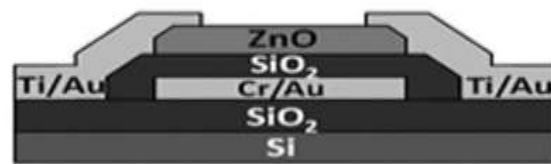
Figure II.4: Transistor à base d'oxyde de zinc [122].
