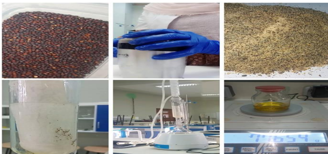
Figure 23: Etapes d'extraction de l'huile (exemple applique) travail par Soxhlet
