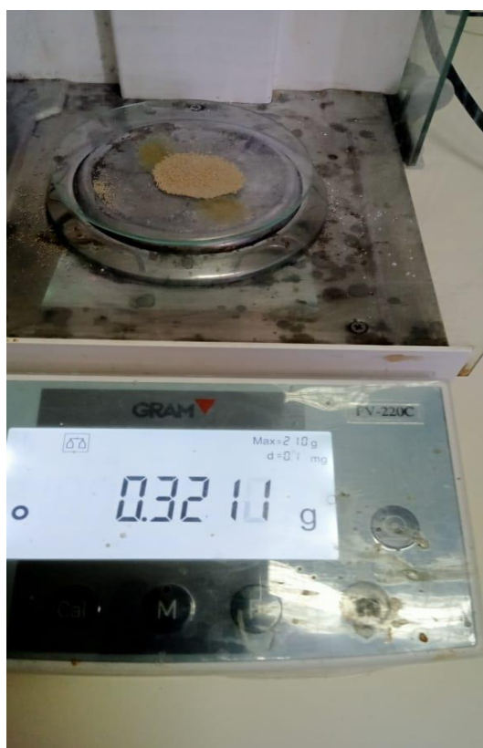
Figure 33: Pesée de la levure (0.3211 g) à l'aide d'une balance analytique GRAM FY-220C
