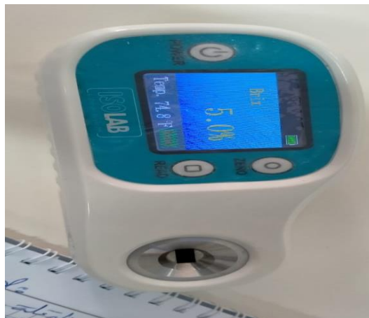
Figure 27: Mesure du taux de sucres (Brix = 5.0%) à l'aide d'un réfractomètre numérique (ISOLAB) lors de la fermentation
