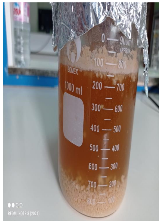
Figure 31: Aspect du milieu de fermentation alcoolique — formation de mousse en surface et dépôt de levures au fond
