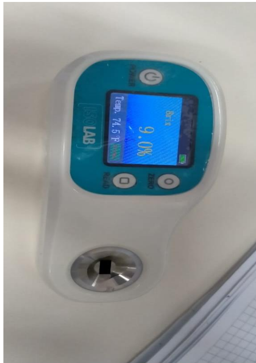
Figure 30: Réfractomètre numérique ISOLAB — Brix = 9.0% — Temp. 74.5°F
