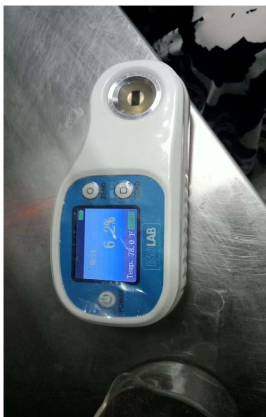
Figure 29: Mesure du taux de sucres (Brix = 6.2%) à l'aide du réfractomètre numérique ISOLAB — Temp. 78.0°F
