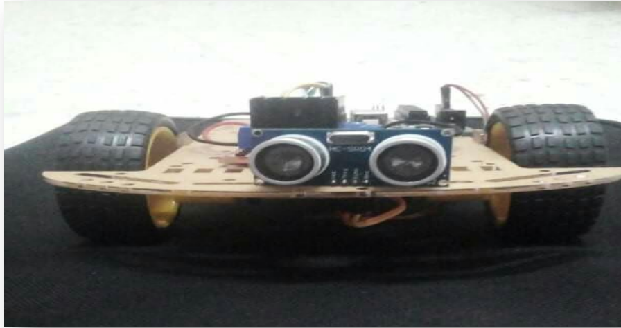
Figure III.20 : Mise en place du capteur HC_SR04.
