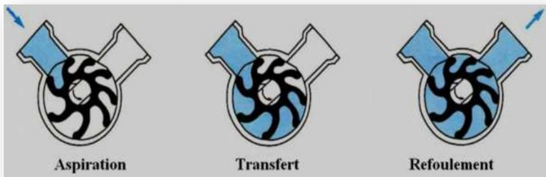
Figure 5. Pompes à palettes flexibles[7]
