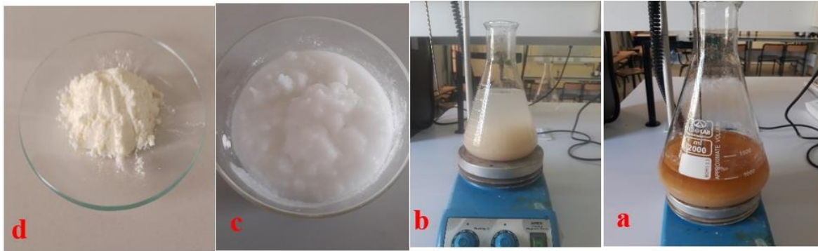
الشكل 2.II. مراحل استخلاص السليلوز، (a) تمثل المعالجة القاعدية و الحامضية، (b) مرحلة التبييض، (c) السليلوز قبل تحويله الى نانوسليلوز، (d) نانوسليلوز بعد التجفيف.
