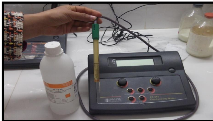
Figure 06 : Mesure de conductivité (photo original)
