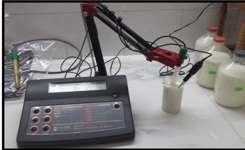
Figure 05 : Mesure du pH (photo original)
