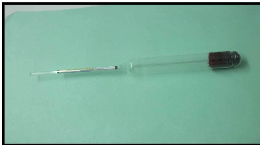
Figure 07 : Lactodensimètre (photo original)
