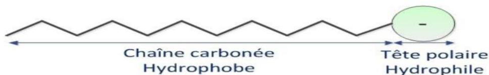
Figure 08. Structure schématique d'un tensioactif
