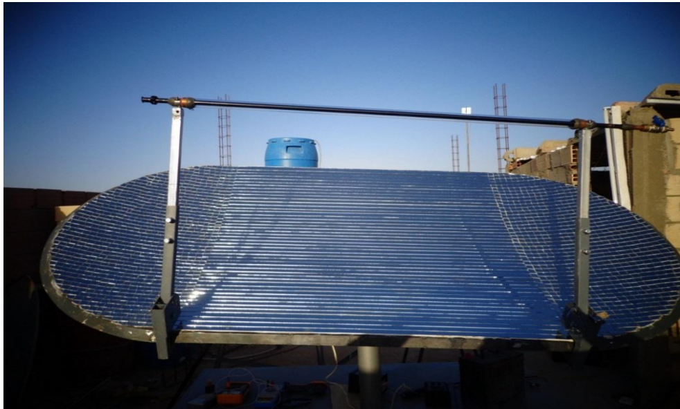
Figure. III.07 : Réflecteur et support du tube récepteur
