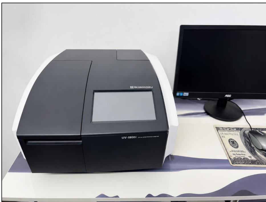
الشكل (III – 10): جهاز مطيافية الأشعة فوق البنفسجية -المرئية (UV-Vis)
