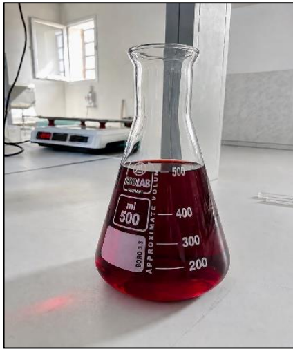
الشكل (III - 2): قياس كتلة أحمر الكونغو الشكل (III - 3): محلول مائي لأحمر الكونغو بتركيز 1000 ppm
