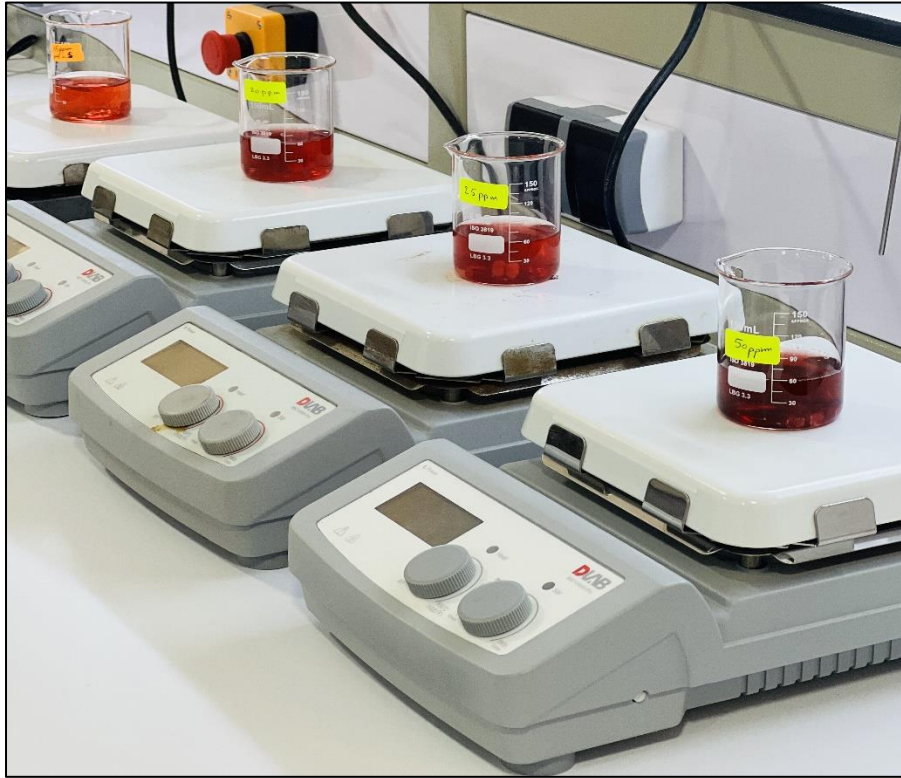
الشكل (III – 5): العينات تحت التحريك باستعمال مخلاط مغناطيسي بسرعة 350 rpm
