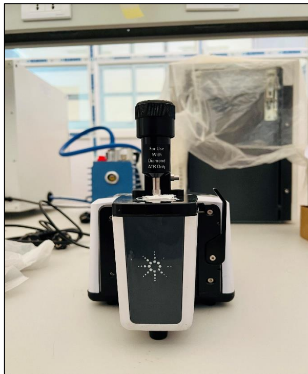
الشكل (III – 9): جهاز مطيافية الأشعة تحت الحمراء Spectrometer A gilent Technologies Cary 630 FTIR
