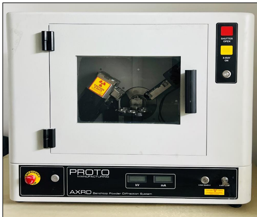
الشكل (III – 8): جهاز الانعراج الألي من نوع PROTO AXRD Benchtop powder diffraction
