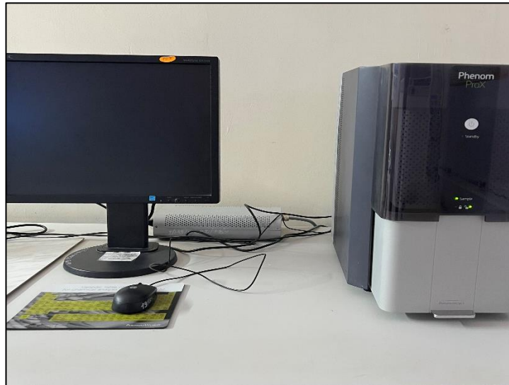
الشكل (III – 11): جهاز المجهر الإلكتروني الماسح المقترن بالتحليل الطيفي للأشعة السينية المشتتة للطاقة Phenom Prox DESKTOP SEM/EDS
