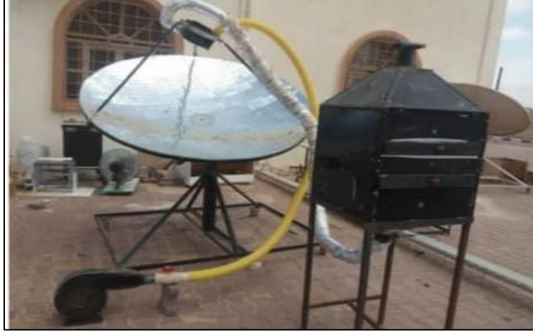
الوثيقة رقم 15: صورة توضح مجفف حراري
