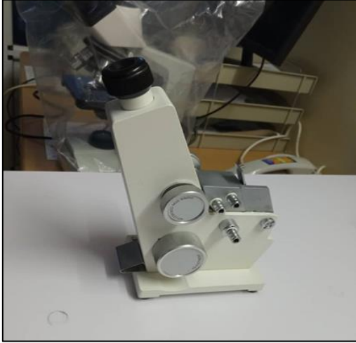
الوثيقة رقم 22: جهاز قياس قرينة الإنكسار Refractomètre
