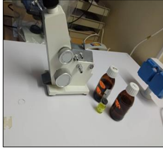
الوثيقة رقم 22: جهاز قياس قرينة الإنكسار Refractomètre
