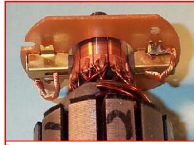
Figure I.5 : Balais montés sur collecteur.[8]
