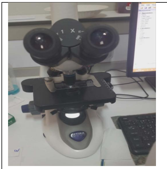
Figure 19 : système de microscopie optique relié a un ordinateur utilisé pour l'observation des grains de pollen
