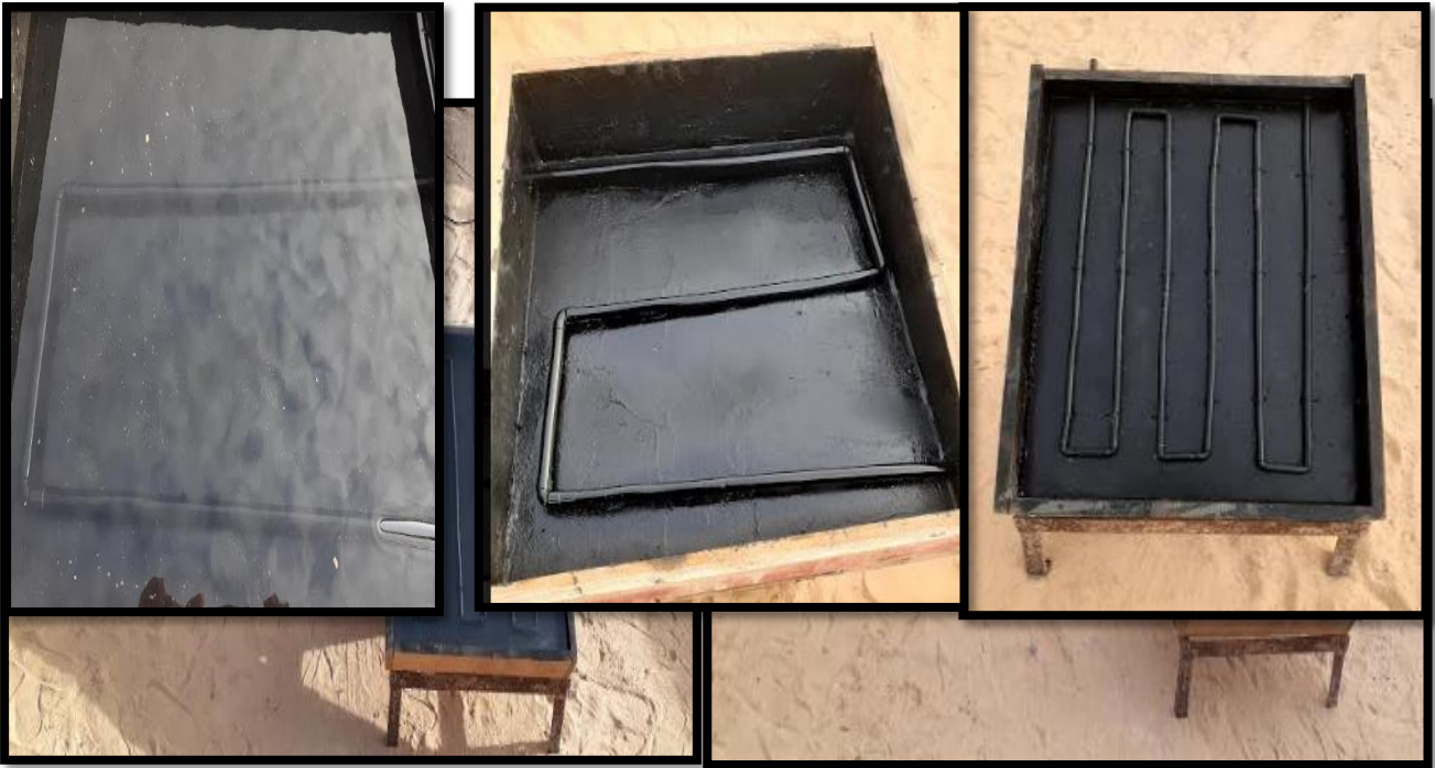
الشكل (3-8): صورة توضيحية للمقطر الشمسي الشاهد والمحسن قبل و بعد التجربة.
