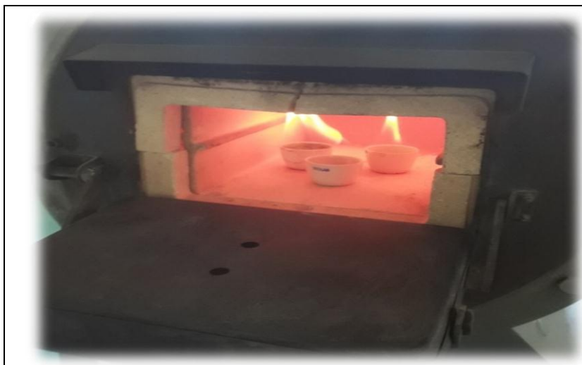
صورة 10: عملية حرق عينات أصناف القمح في فرن Four à Moufle
