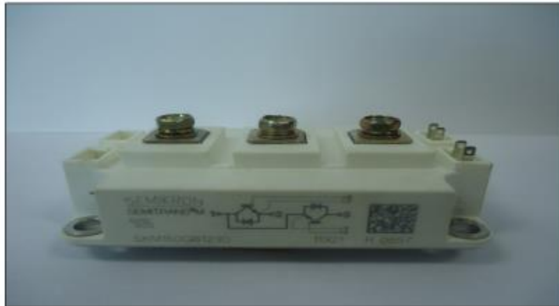
Figure I.7. Photo d'un module IGBT SKM 150GB 123D
