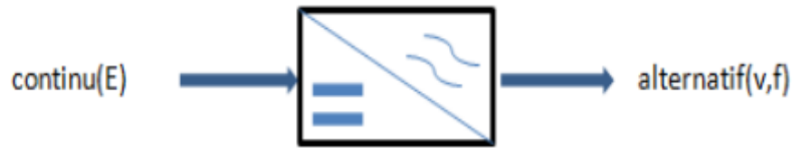
Figure I.10. Schéma bloc représentatif d'un onduleur
