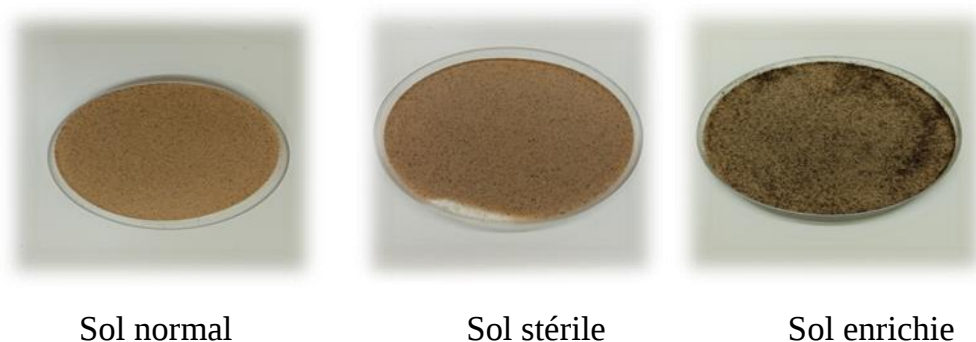
Figure 20 : Matrices utilisées pour l'enfouissement des bioplastiques
