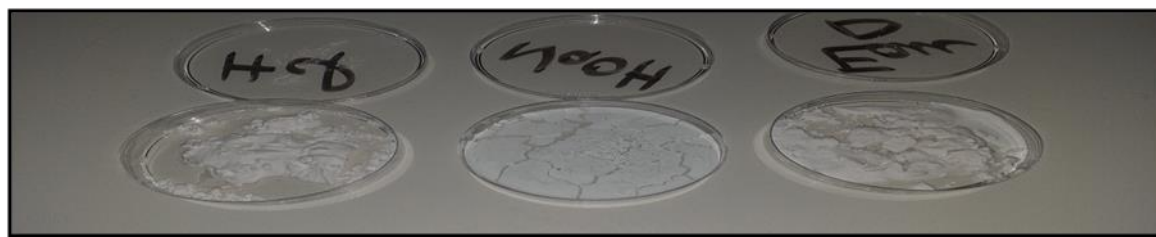
Figure 17 : Amidon extrait dans par les trois solutions (Eau D : amidon de solution neutre, NaOH : amidon de solution basale, Hcl : amidon de solution acide).
