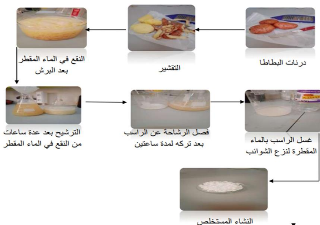
الشكل رقم 22. يوضح طريقة استخلاص النشاء.
