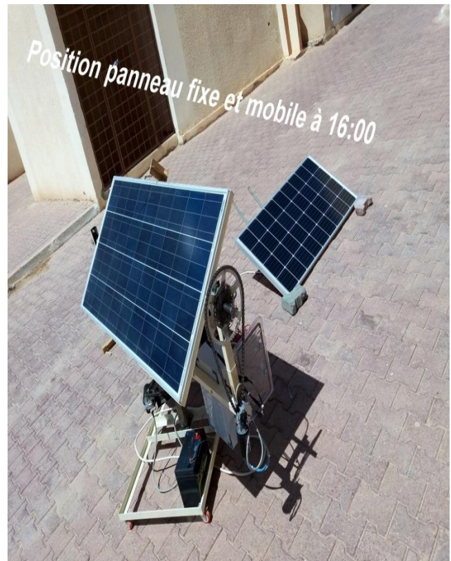
Figure (IV-9): Les positions des panneaux solaires pendant les mesures
