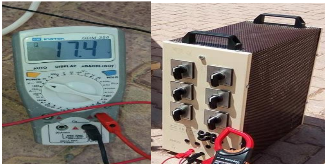
Figure (IV-8) : l'ampèremètre + voltmètre + la résistance variable
