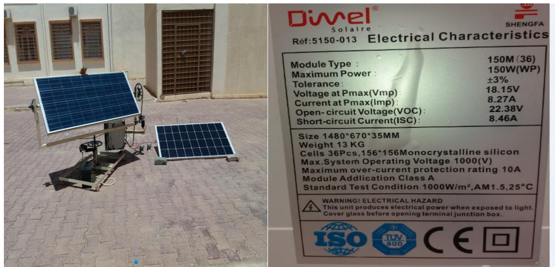
Figure (IV-7) : les deux panneaux avec leur Plaque signalétique.
