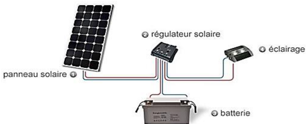
FigureII.2: schéma d'une Structure système photovoltaïque
