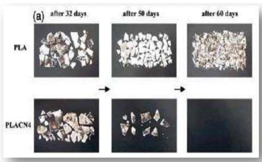
Figure 1.7 : Dégradation accélérée d'un Polylactide (PLA) avec 4% de MMT
