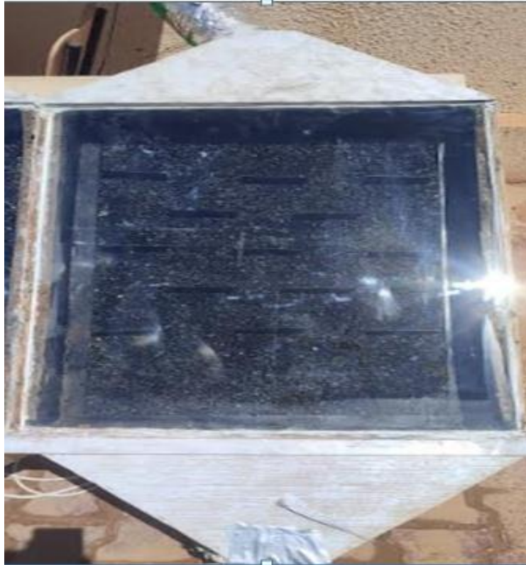
Figure III.8: Photo montrant les chicanes du capteur plan.
