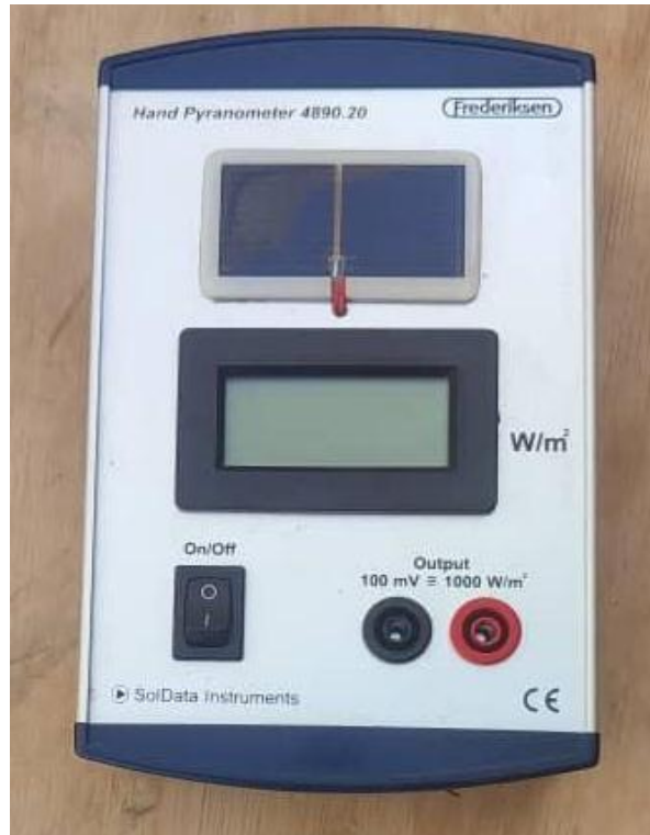
Fig.III.11: Photo du Pyranomètre (Pyranometer 4890.20 "Frederiksen").
