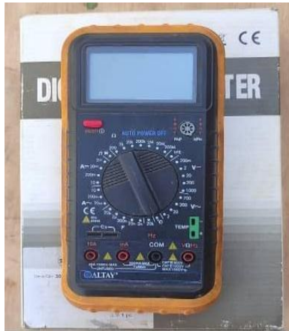
Fig.III.9: Photo du multimètre utilisé pour la mesure de la température ambiante
