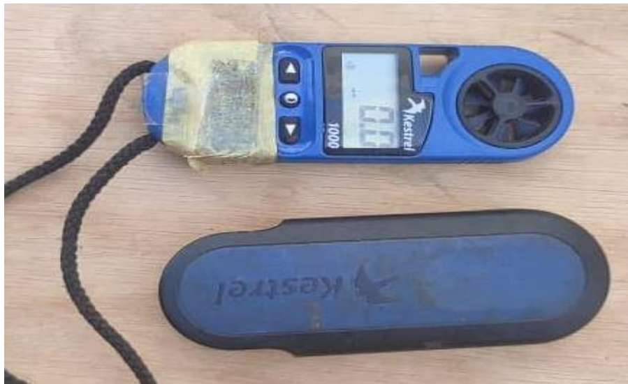
Fig.III.10. Photo du de l'Anémomètre Kestrel 1000.
