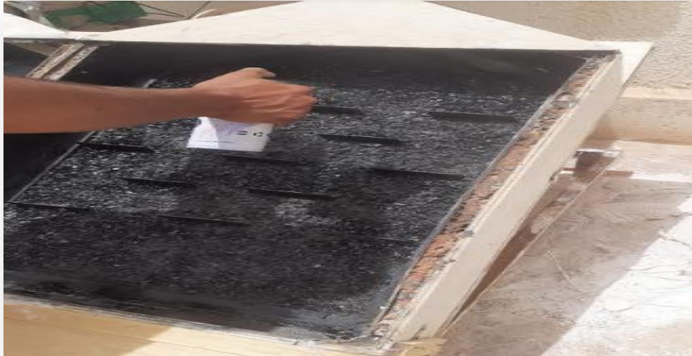
Fig.III.3. Photo montrant la peinture du gravillon dans le capteur à chicanes
