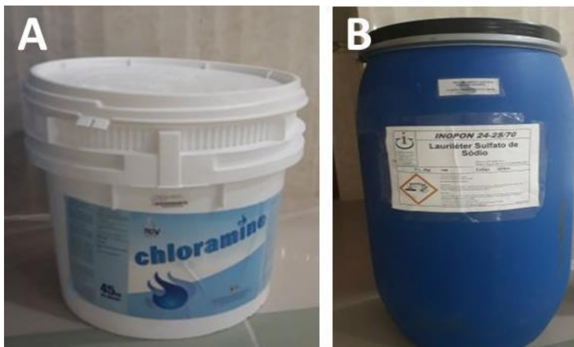
Figure 13. Modèles d'emballage plastique utilisé; A: Emballage plastique de type PolyPropylène pour emballer le chlorure de calcium ( \text{CaCl}_2 ), B: emballage plastique de type polyéthylène Haute Densité pour emballer le laureth sulfate de sodium ( \text{C}_{12}\text{H}_{25}\text{NaO}_4\text{S} ). (photo originale)
