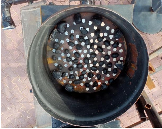
الشكل ( III-3): صورة توضح كيفية وضع المواد المساعدة على حفظ الحرارة (الحصى الأسود والفحم)
