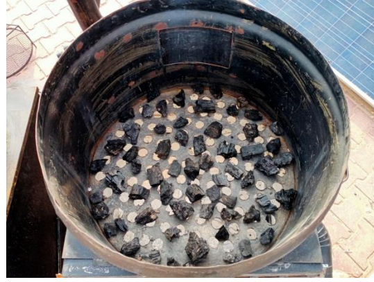
الشكل ( III-3): صورة توضح كيفية وضع المواد المساعدة على حفظ الحرارة (الحصى الأسود والفحم)
