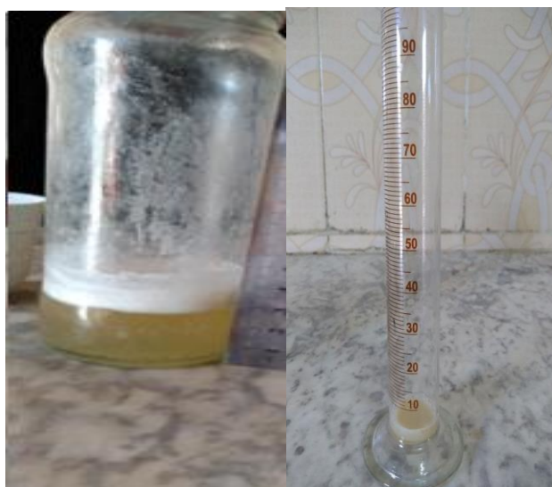
Figure 39. Solubilité du savon, a) dans l'eau distillée ; b) dans l'acide chlorhydrique (Originale, 2020)
