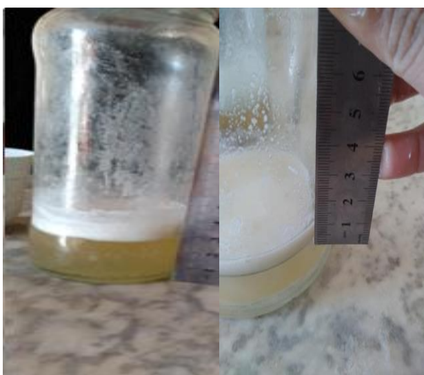
Figure 40. Solubilité du savon ; a) dans l'eau distillée ; b) dans le chlorure de Sodium (Originale, 2020)
