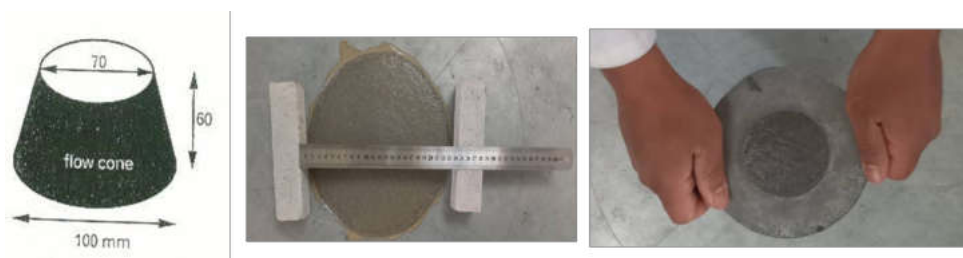
Figure II.21 – Essai d'étalement au mini cône
