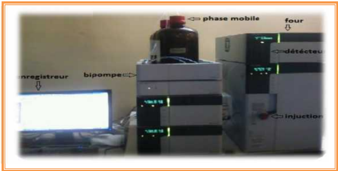
Figure (17): Représente Chromatographie liquide de haute performance d'un HPLC (HEMMAMI et GUEZEI, 2013).
