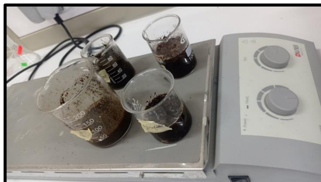
Figure III.6la mélange dans agitation magnétique (photo original,2023).
