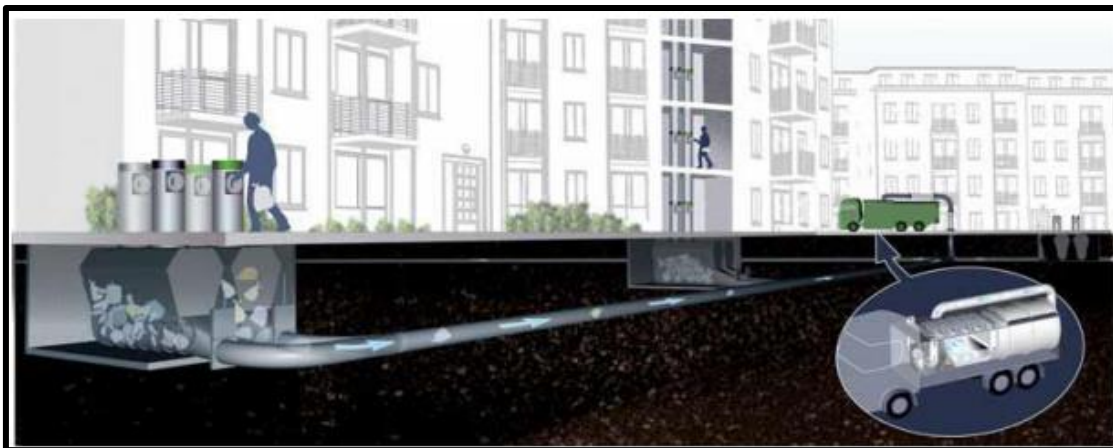
Figure I.2.: Schéma de principe de la collecte pneumatique des déchets ménagers.
