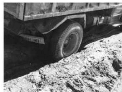
Figure (2.20) : Mécanismes typiques de dégradation des routes non revêtues et non renforcées sur les sols mous.
