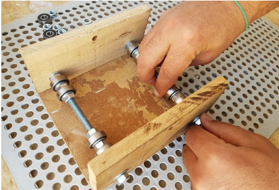
Figure III.3: L'étape d'installation des roulements à la base de glissement
