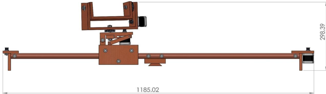
Figure II.23 : dessin technique en 3D de la curseur les dimensions (côté)
