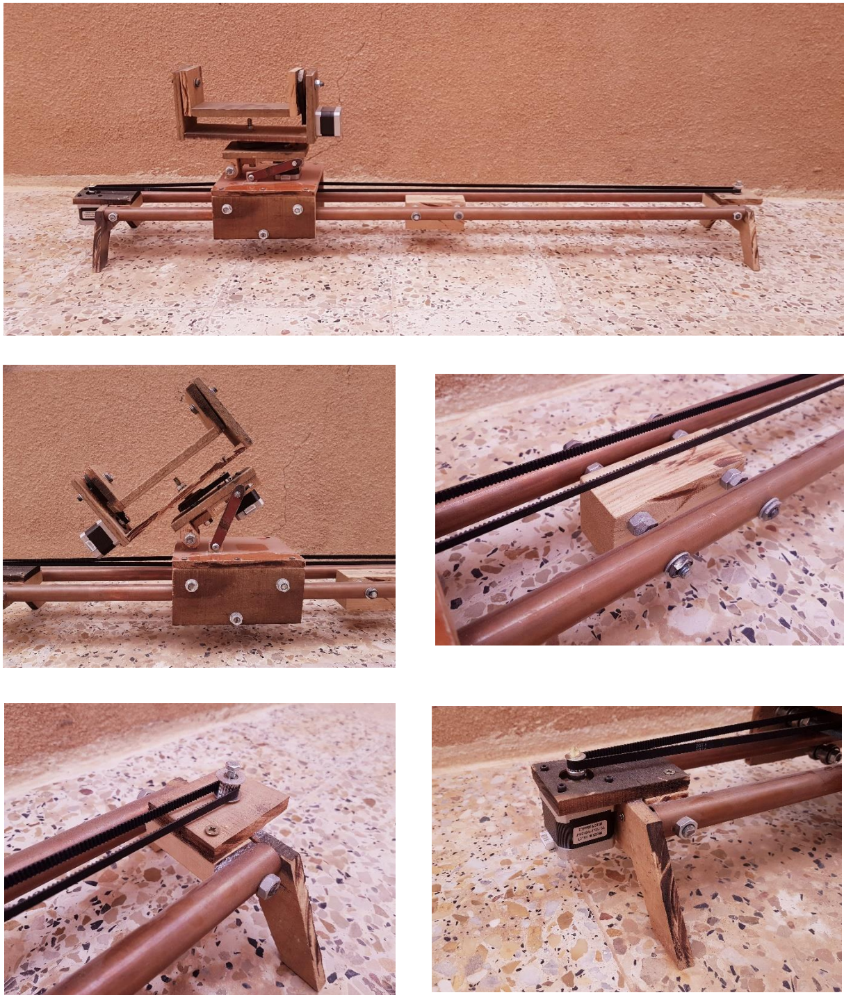
Figure III.17: Images du curseur de la caméra après l'assemblage
