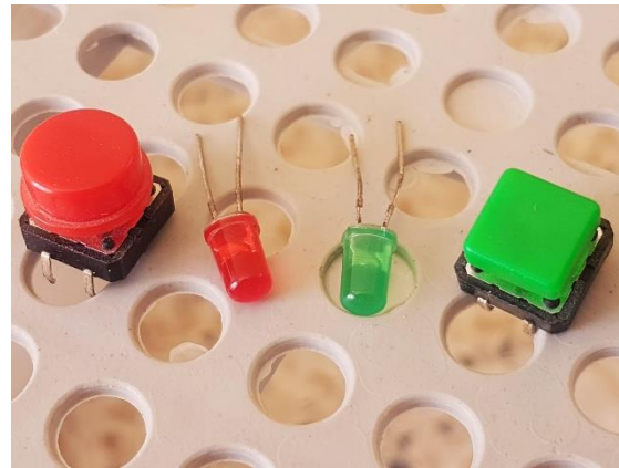
Figure IV.5 : Deux bouton-poussoir Et 2 LED
