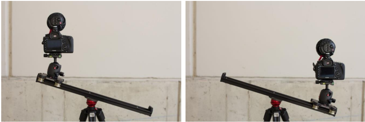
Figure I.8: État du mouvement de la caméra oblique à un angle critique
