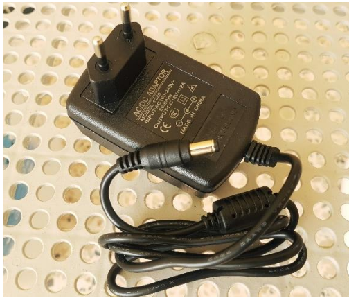
Figure IV.4 : Transformateur électrique (AC/DC-12V/2A)
