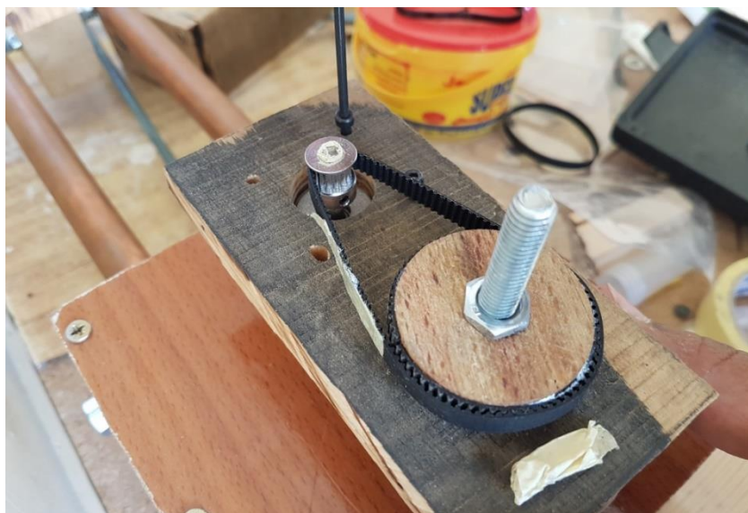
Figure III.13: Le moteur pas à pas est installé sur la surface d'inclinaison
