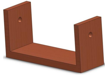
Figure II.7 : Design 3D pour Pièce d'inclinaison et de fixation
