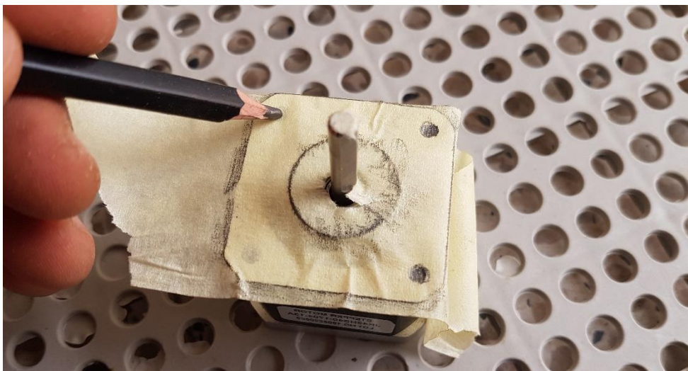
Figure III.11: Méthode de localisation des trous du moteur pas à pas
