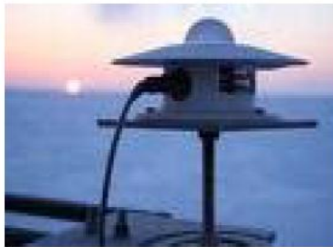
الشكل (I-19): جهاز قياس الإشعاع الكلي لضوء الشمس [7].
