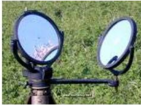
الشكل (I-18): جهاز قياس مدة سطوع الشمس [7].
