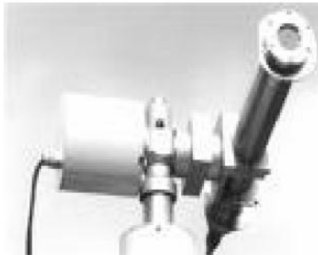
الشكل(21-I):جهاز قياس الإشعاع الشمسي المباشر [7].
