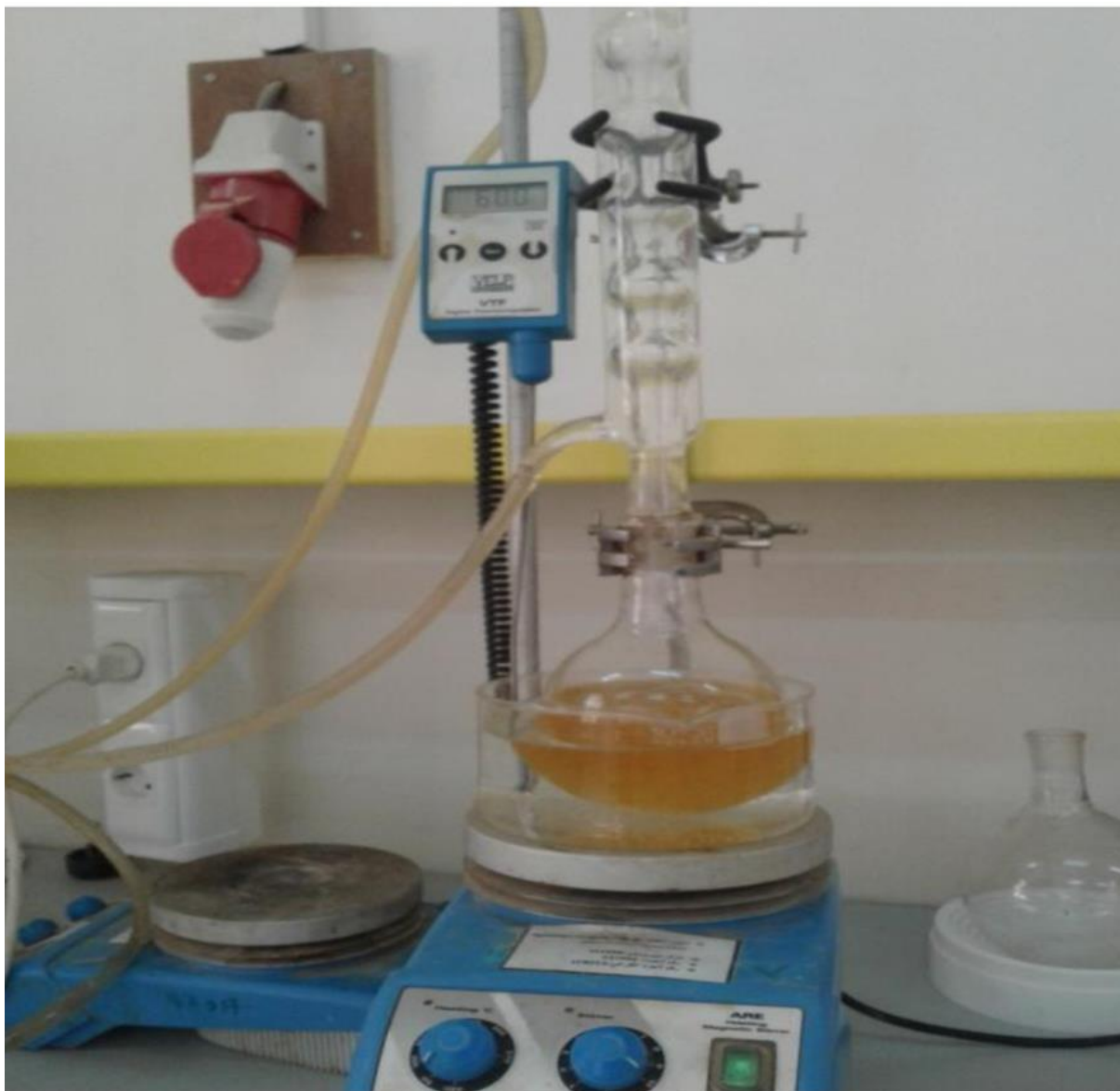
Figure III-4: montage de la réaction de transestérification.
