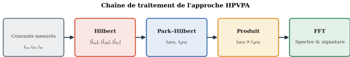
Figure II. 6 Chaîne de traitement de l'approche HPVPA, du courant mesuré à la signature spectrale.
