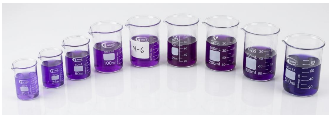
الشكل (III-8): صور فوتوغرافية لمحاليل صبغة CV مختلفة التراكيز لتحديد منحنى لمعايرة
