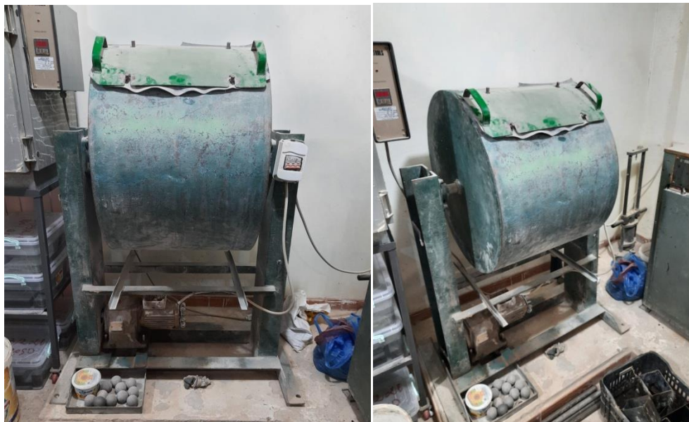
Figure(III.7):La Machine « Los Angeles » et Les Boulets
