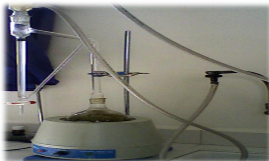
Figure 08: appareille d'hydrodistillation (Clevenger) (Pibiri M., 2006).
