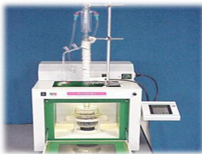
Figure 11: montage d'extraction par micro-onde (El Haib A., 2011).
