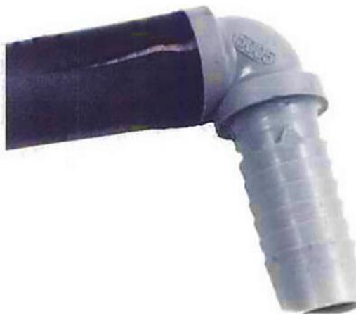
Fig.II.3. Fissuration sous contrainte en milieu tensioactif d'un tuyau de polyéthylène.
