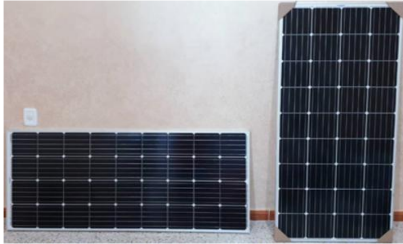
Fig. V.3. Modules photovoltaïques étudiés de type RAGGIE (modèle RG-M165W).
