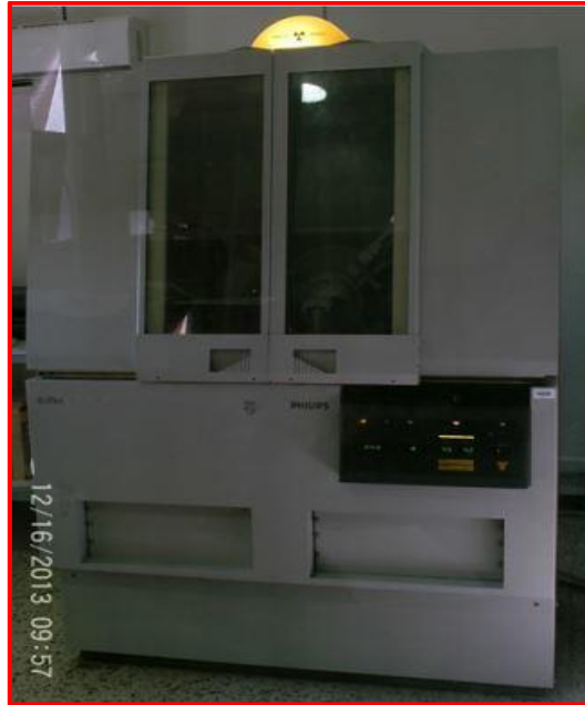
الصورة (III.7): جهاز XRD.
