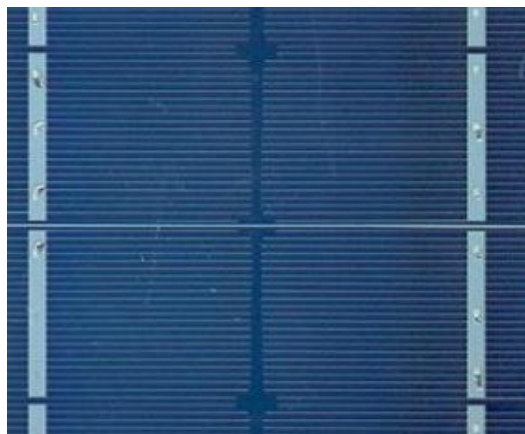
Figure I.7: Cellule solaire de type poly-cristalline.
