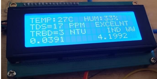
الشكل (34): صورة حقيقة للشاشة تظهر نتيجة المياه الصناعية
