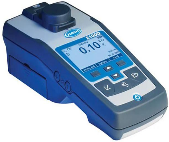
الشكل (7): أجهزة قياس العكارة المحمولة
