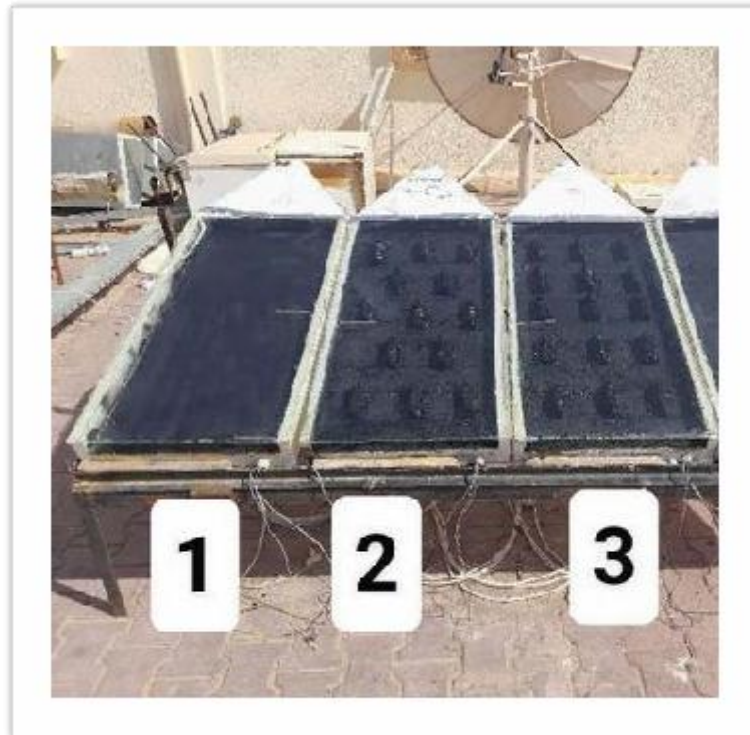
Photo III.1: Les trois capteurs solaires fabriqués.
