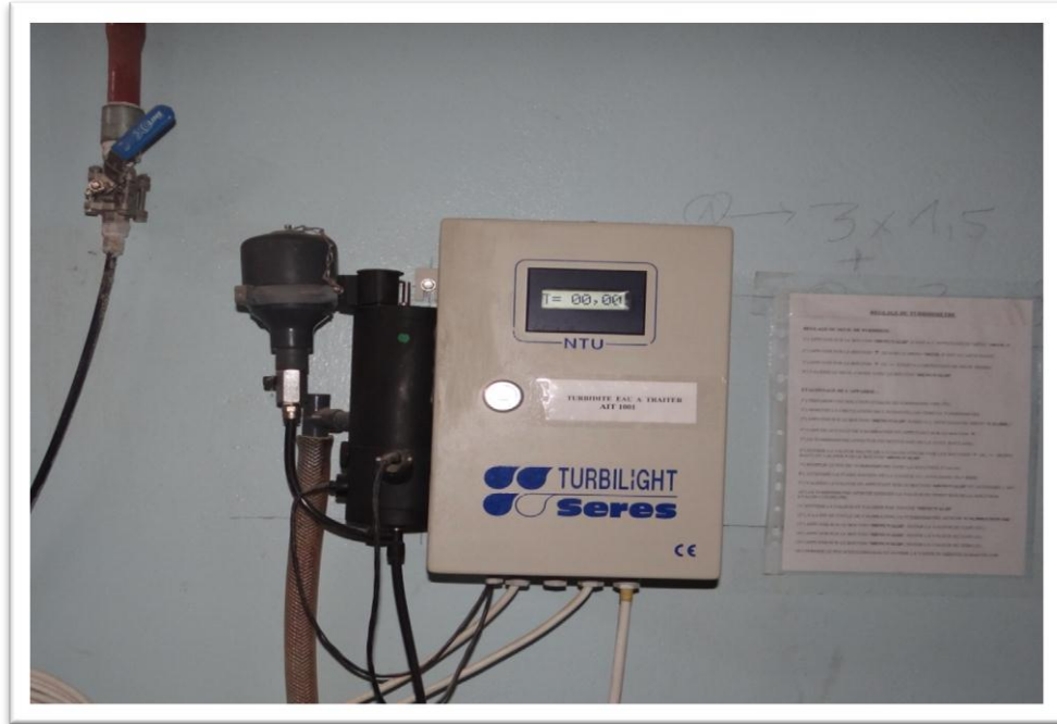
الصورة (3 - 04) : توضيح جهاز قياس الشفافية
