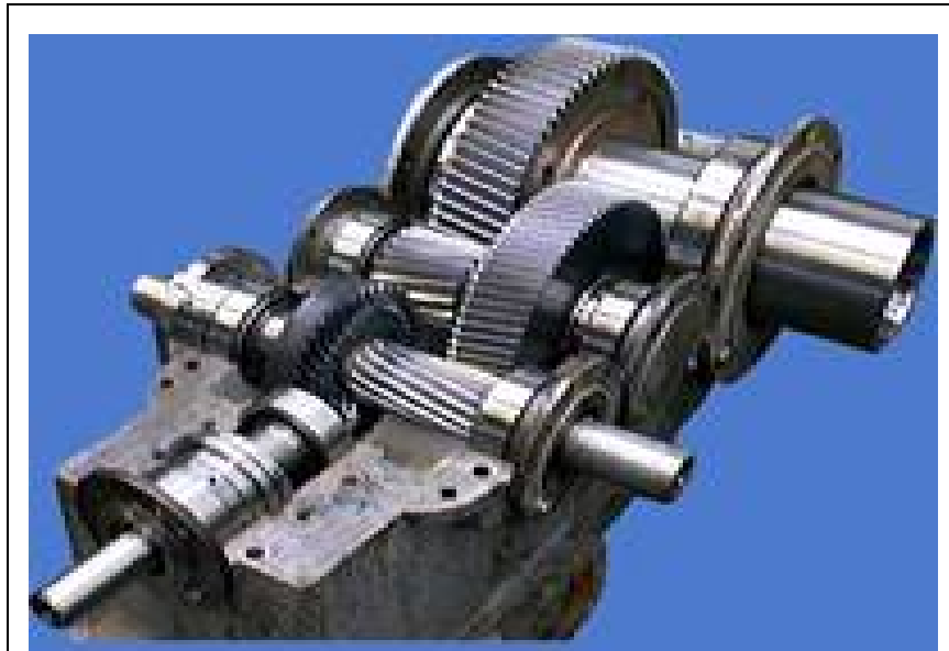
Figure. . I.2: Réducteur cylindrique à denture hélicoïdale.[6]
